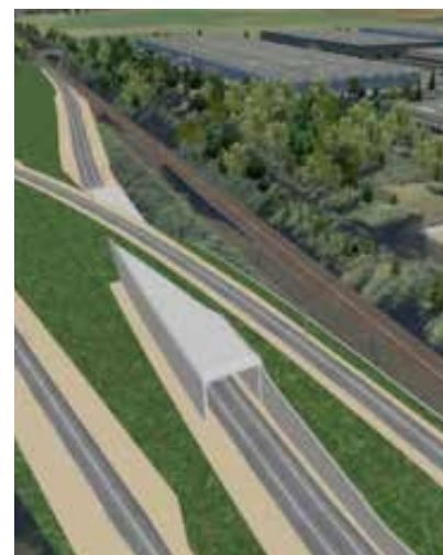
Vue 3D du saut de mouton (franchissement dénivelé pour éviter un cisaillement)
