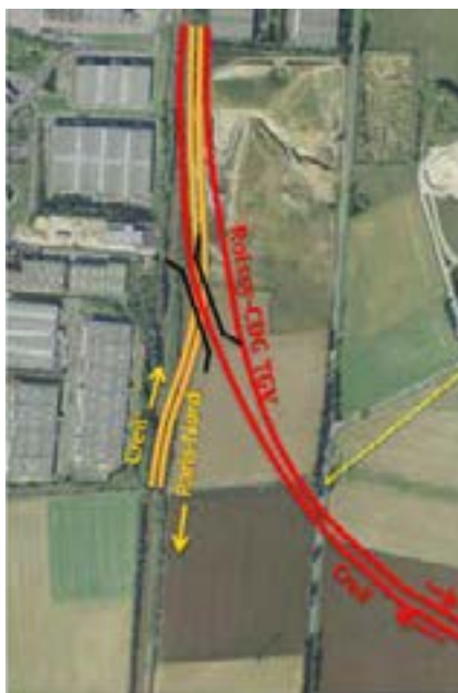
Vue 3D du saut de mouton (franchissement dénivelé pour éviter un cisaillement)
