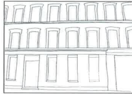
Baies avec tableaux axées sur l'étage
