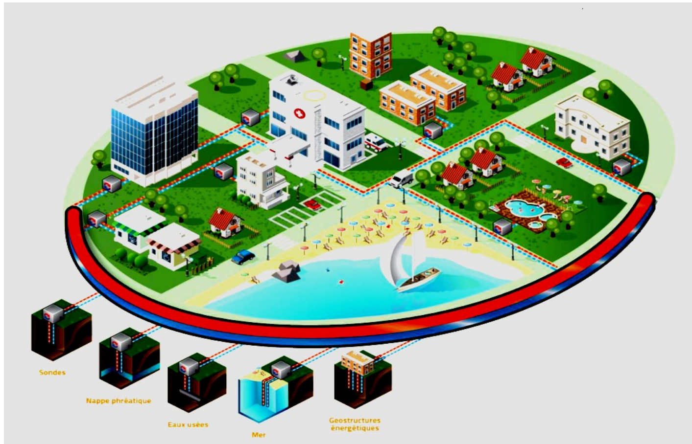
Illustration 66: Les différentes sources de captage pour une boucle d'eau tempérée. Source : AFPG.
