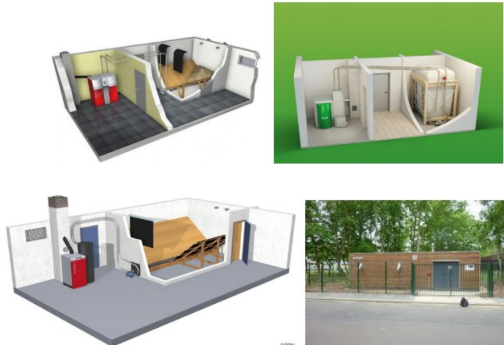
Illustration 49: Exemples de chaufferies et de silos biomasse
