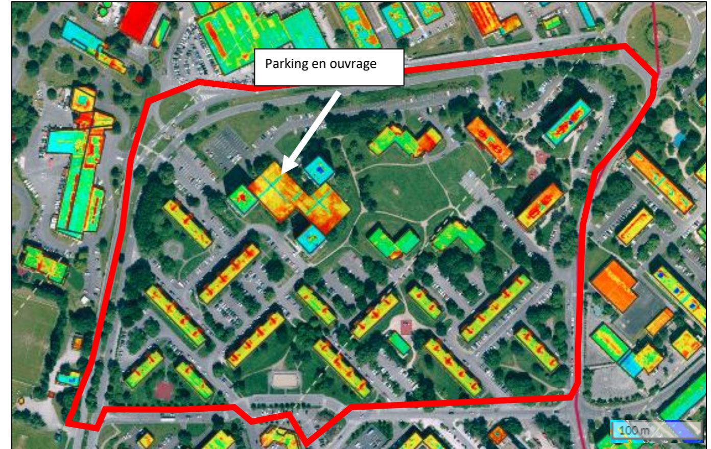
Illustration 120 : Carte thermique des isolations de toiture sur l'aire d'étude des Musiciens (Agglo de Compiègne)
