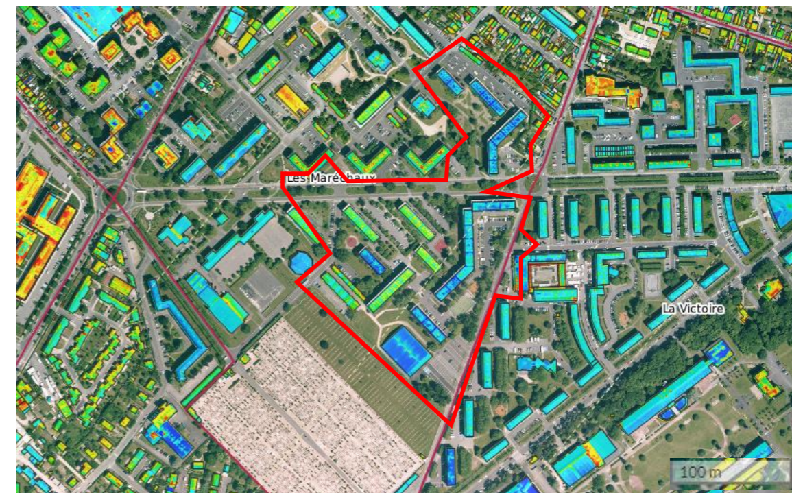
Illustration 121 : Carte thermique des isolations de toiture sur l'aire d'étude des Maréchaux (Agglo de Compiègne)
