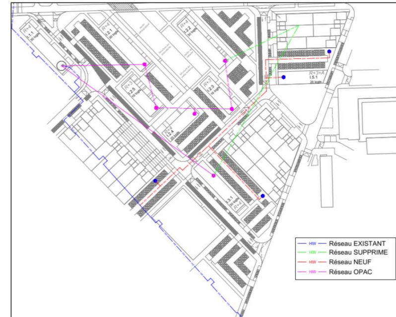
Illustration 31 : Travaux RCU – Maréchaux (source : Note de dimensionnement – ANRU 2 – RCU)
