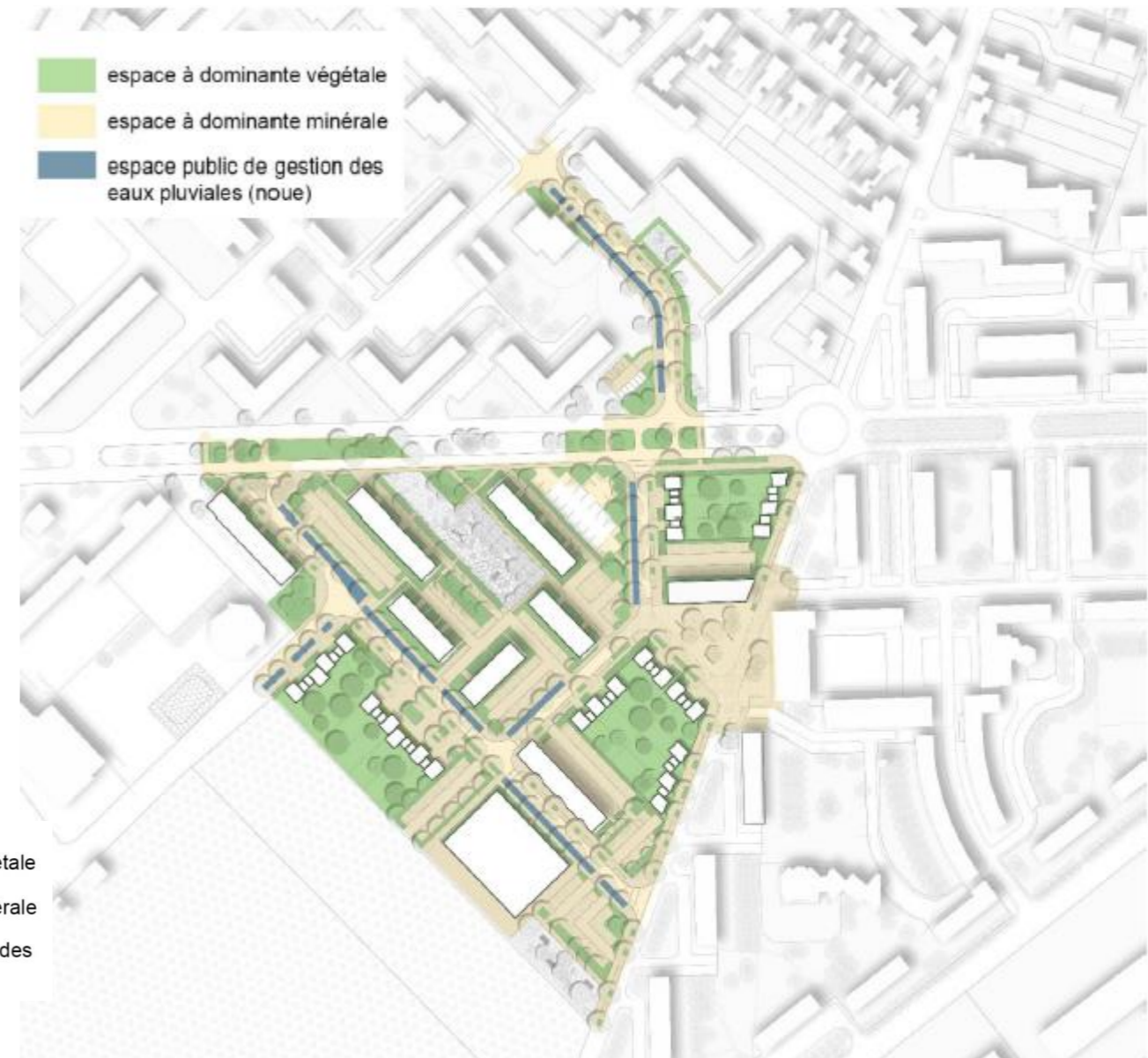
Illustration 28 : principes d'hydraulique douce envisagés sur le secteur des Maréchaux
