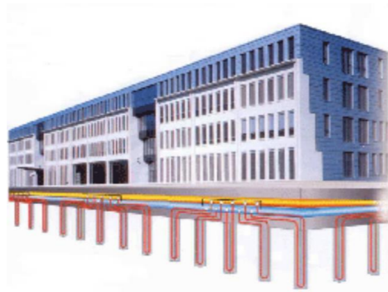
Illustration 35 : Fonctionnement de la géothermie sur géo-structures
